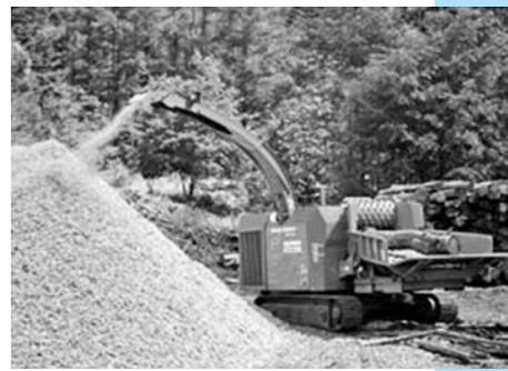
右／大型機械を導入し、不要な木材をチップ化上／木質チップは、燃料として専用のボイラーで使用されます
