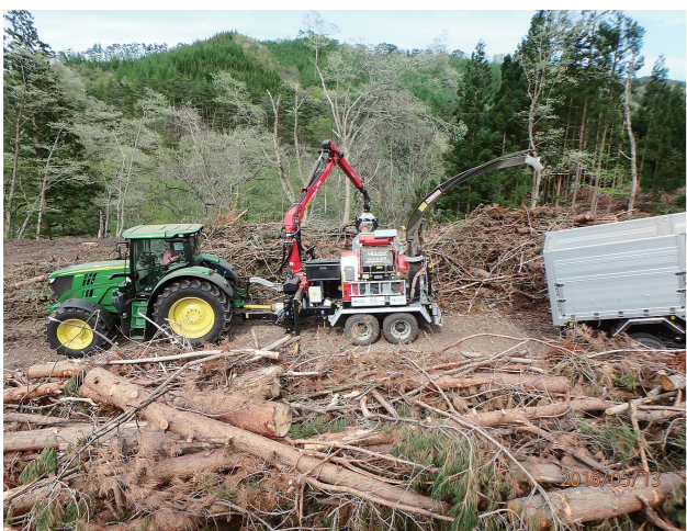
トラクターを動力源とする移動式チップパーは、林地の間伐材や支障木を現地でチップ化する。
