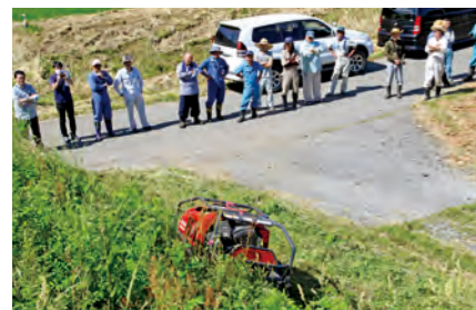
ラジコン型草刈機で法面の草刈りを実演
